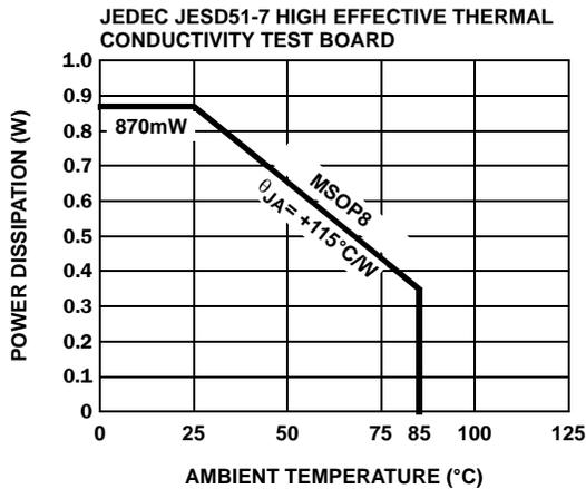
FIGURE 9. PACKAGE POWER DISSIPATION vs AMBIENT TEMPERATURE
