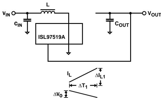
FIGURE 12. BOOST CONVERTER - CYCLE 1, POWER SWITCH CLOSE
