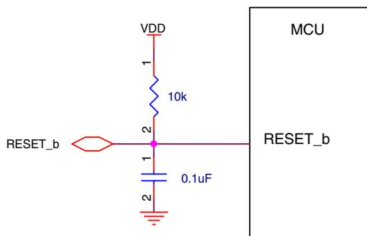
**Figure 32. Reset circuit**
