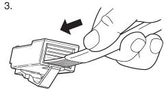
図のように導線を挿入する側を手前にしラッチ部を下に向けると左側が1番ピンとなりますので挿入順番を確認して慎重にしっかりと奥まで挿入する
