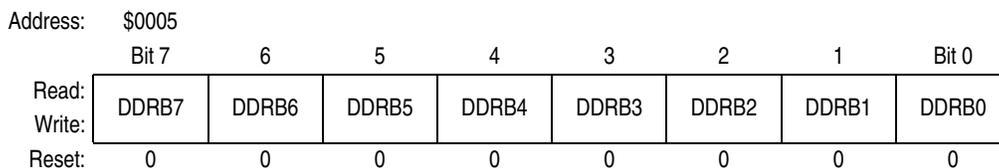
Figure 10-6. Data Direction Register B (DDRB)
