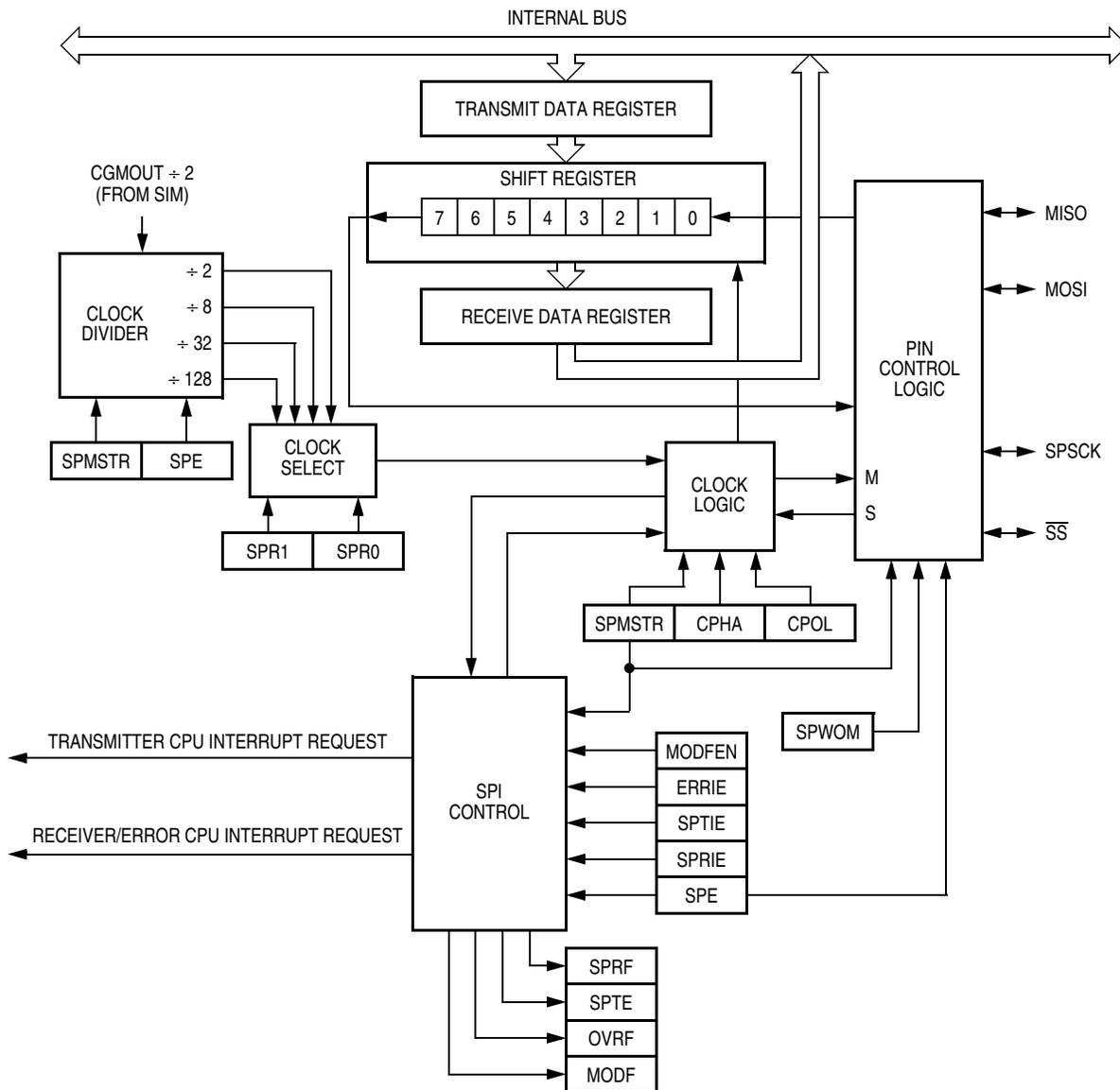
Figure 15-2. SPI Module Block Diagram
