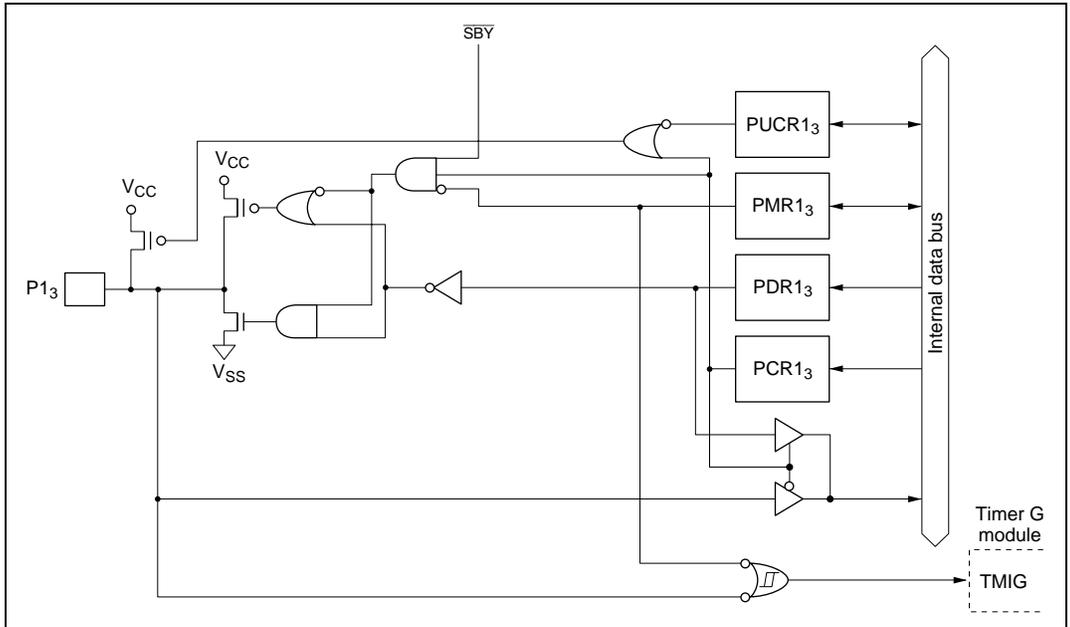
Figure C.1 (b) Port 1 Block Diagram (Pin P13)
