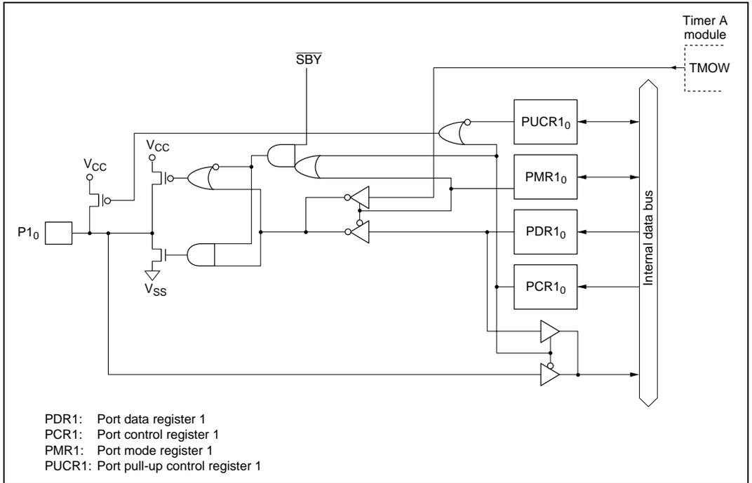
**Figure C.1 (d) Port 1 Block Diagram (Pin P1<sub>0</sub>)**
