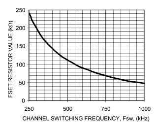
FIGURE 4. CHANNEL SWITCHING FREQUENCY vs R<sub>FSET</sub>
